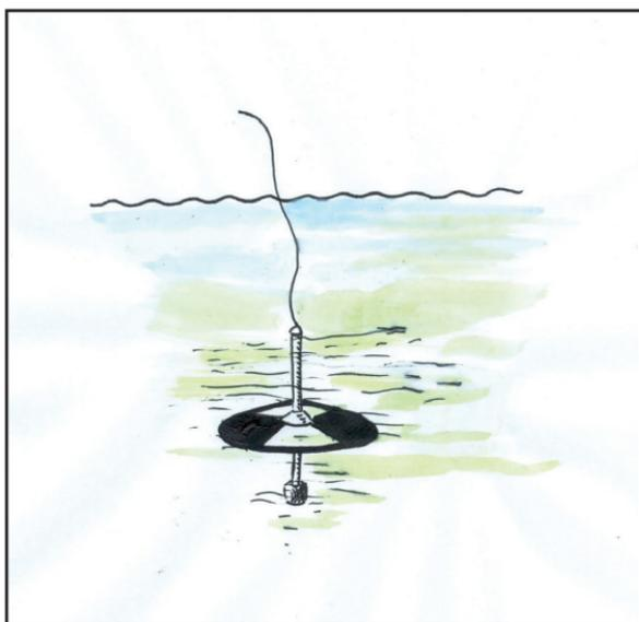
*Figura 13: Disco de Secchi, usado en los cultivos para determinar la turbidez del agua.*
